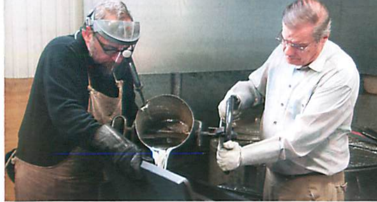
Gießen von Metallplatten aus Zinn.
